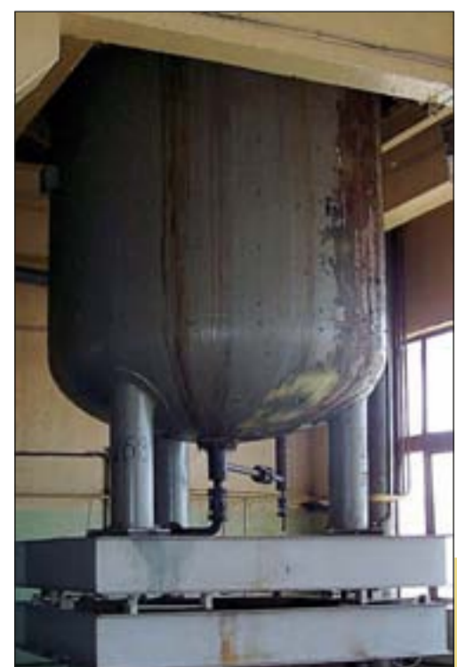
Мешалка, занимающая несколько этажей Преобразователь частоты EI-7011 привода мешалки мощностью 55 кВт
