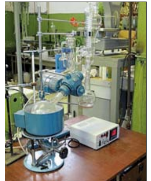
Испаритель ротационный ИР-1М3 с преобразователем частоты E3-8100
