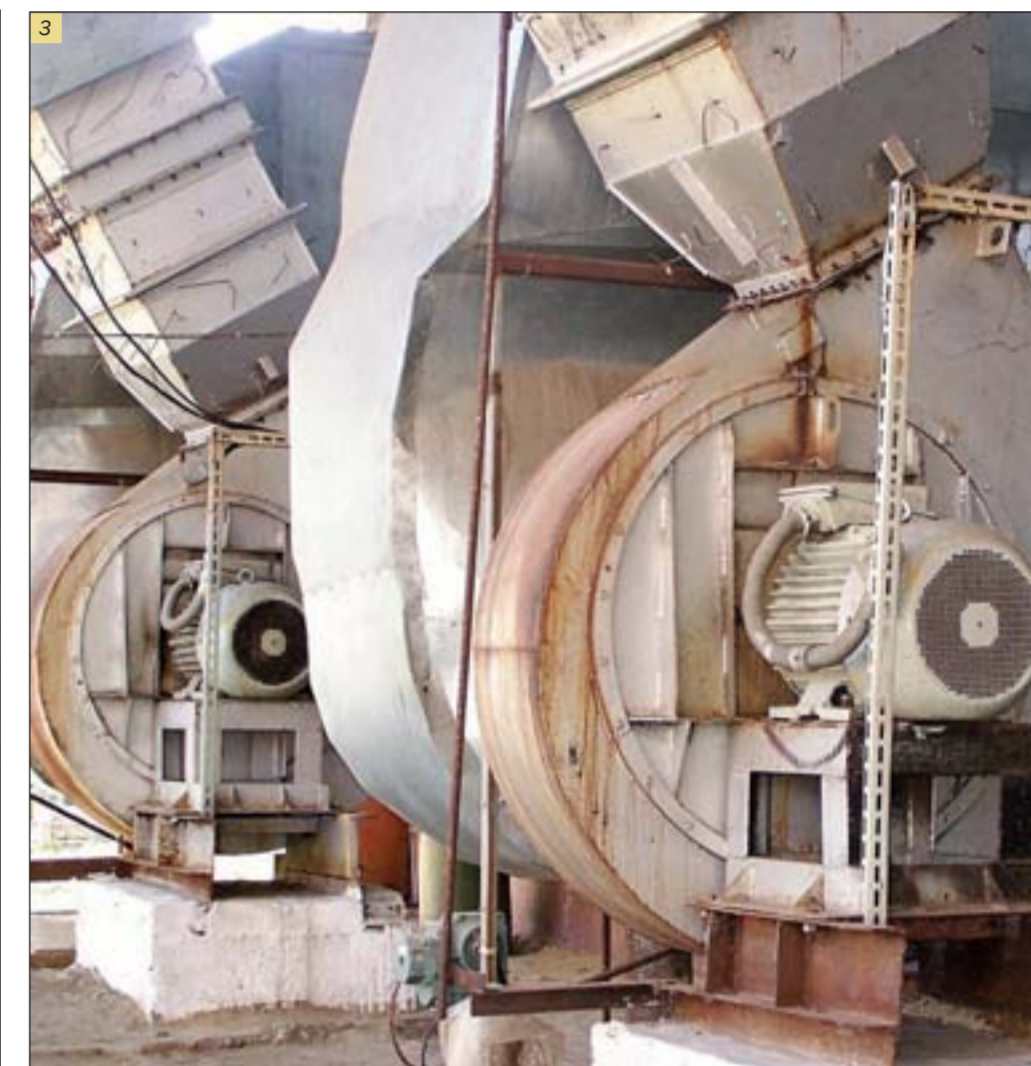
1. Инженер конструктор ОГК Вахрамеев Александр Владимирович. 2. Градирня цеха изготовления топливных добавок. 3. Приводом дутьевых вентиляторов управляют преобразователи частоты. 4. Центральный пульт управления цеха приготовления топливных добавок. На переднем плане слева направо заместитель начальника цеха по технологии Андрианов Руслан Владимирович, начальник участка электроцеха Рыков Виктор Витальевич
